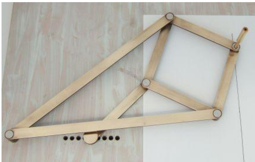
Obr. 5 Peaucellierov inverzor s ramenom zabezpečujúcim pohyb bodu P po kružnici a jeho náčrt
